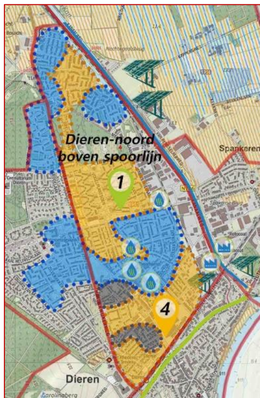
Figuur 52: Toepassing van het voorkeursalternatief in Dieren-Noord boven spoorlijn. In de blauwe gebieden wordt een LT/MT collectieve voorziening voorgesteld. Zie bijlage 10 voor een totaalkaart van de voorkeursalternatieven.
