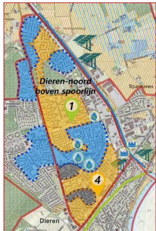
Figuur 12 Toepassing van het voorkeursalternatief in Dieren-Noord boven spoorlijn. In de blauwe gebieden wordt een LT/MT collectieve voorziening voorgesteld. Zie bijlage 9 voor een totaalkaart van de voorkeursalternatieven.
