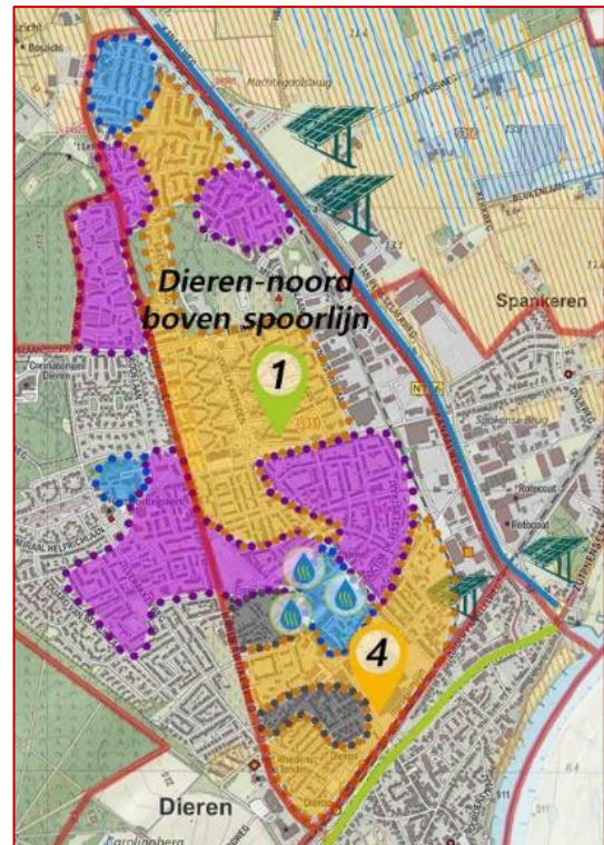
Figuur 53: Toepassing van het back-up alternatief in Dieren-Noord boven spoorlijn. In de paarse gebieden wordt een individuele all-electric invulling voorgesteld. Zie bijlage 11 voor een totaalkaart van de back-up alternatieven.
